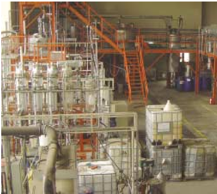
Ausschnitt des UDT-Technikums: Pilotanlagen zur Nassoxidation von Sonderabfällen (Vordergrund) und zur Extraktion von Naturstoffen (Hintergrund)
