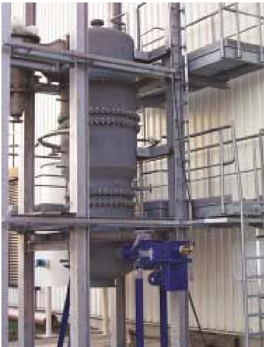
Stationäre Wirbelschicht zur Vergasung und Verbrennung von Biomasse
