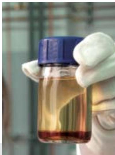
Stickstoffhaltige Katalysatoren beschleunigen die Phasentrennung und Produktaufbereitung bei der Biodiesel-Synthese
