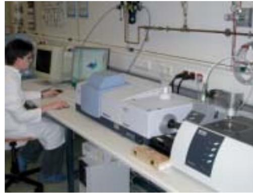
Kopplung Thermogravimetrie/Infrarotspektroskopie (TG-IR)
