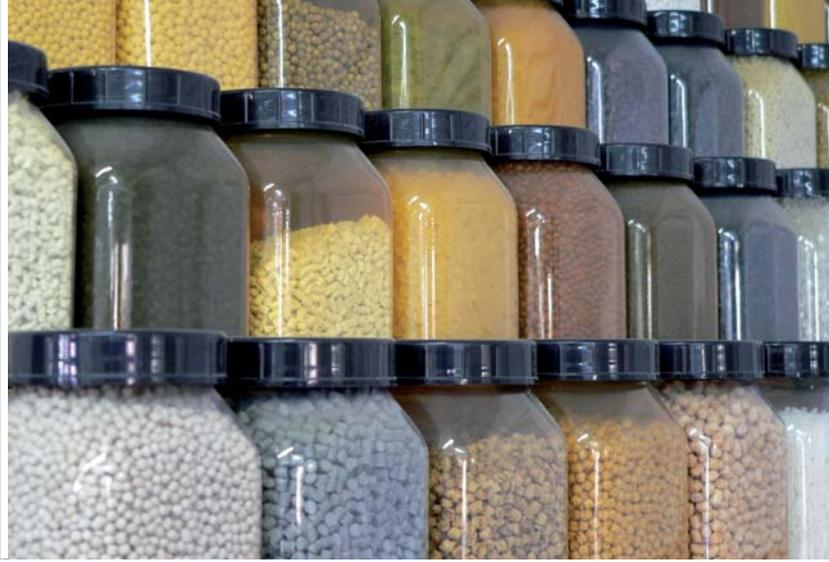
auf den industrienahen Anlagen im Compoundiertechnikum in Willich hergestellt werden. Dazu stehen 5 Doppelschneckenextruder mit Durchsatzleistungen von 10 bis 600 kg/h zur Verfügung. Die so erreichbaren kurzen Entwicklungszeiten bieten unseren Auftraggebern einen Marktvorsprung bei der Produkt-einführung.
