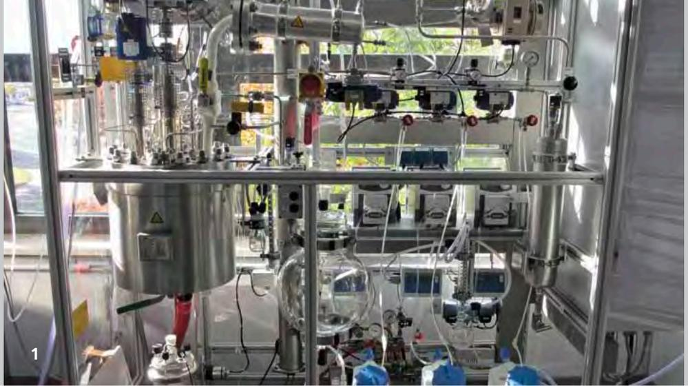
1 Anlage zur großskaligen Präparation von Katalysatoren.
