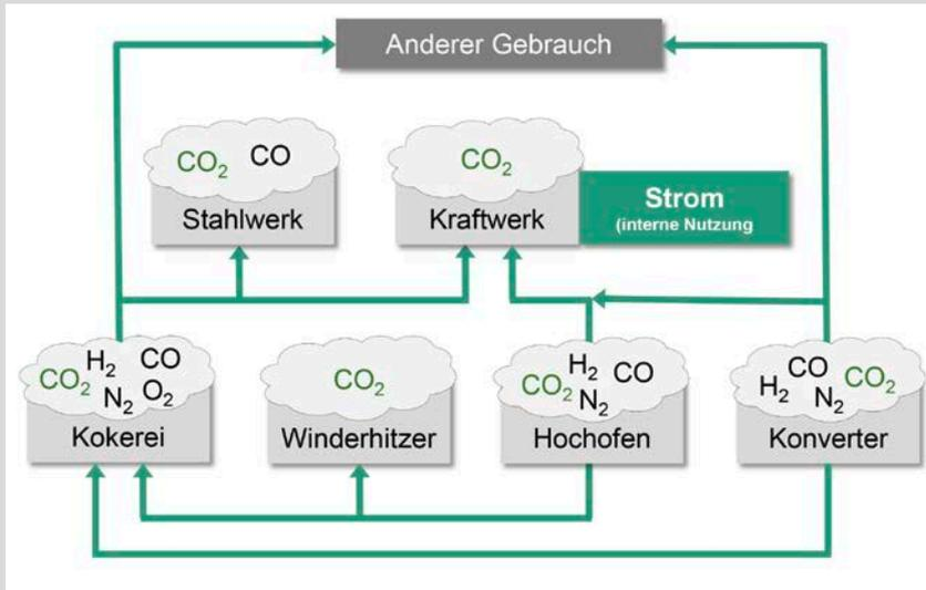
Abbildung 16: Hüttengasanfall und Komponenten in einem integrierten Stahlwerk.
