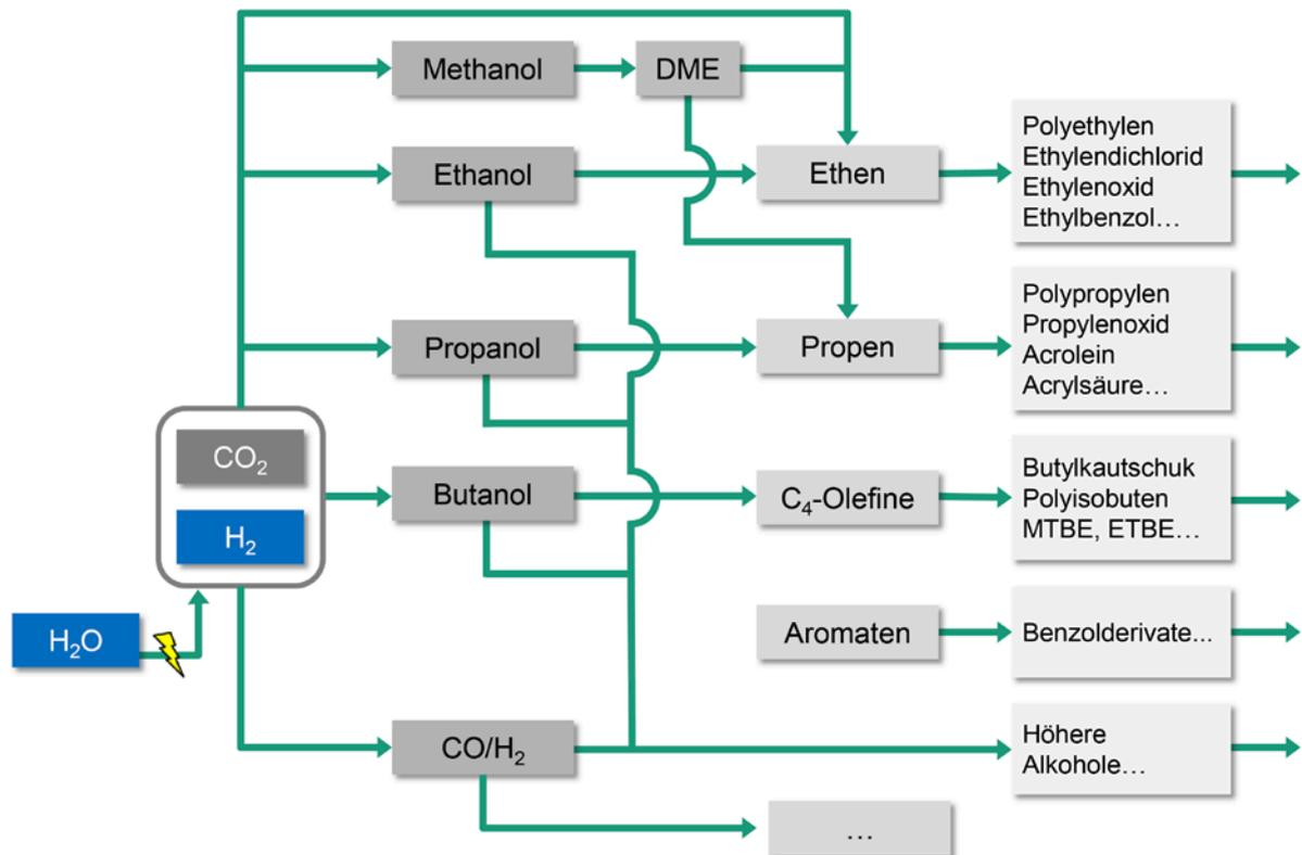
Abbildung 9: Schema Produktstammbaum für chemische Produkte aus Strom und CO<sub>2</sub> (vgl. hierzu Abbildung 2).
