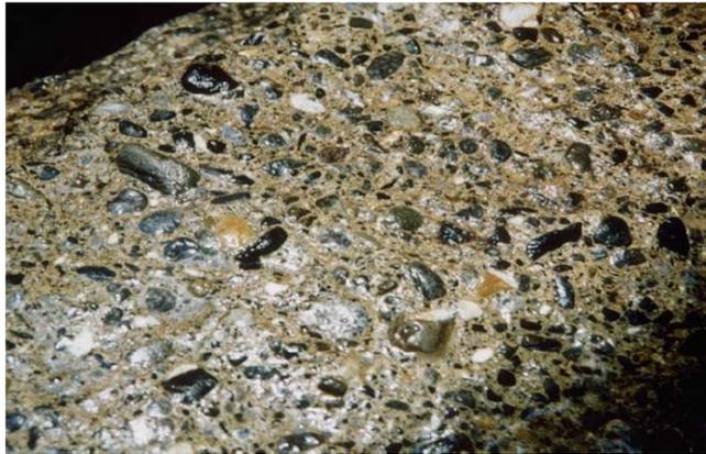
Abbildung 4: Ausgewaschene Betonmatrix<sup>26</sup>
