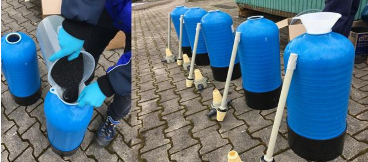
Abbildung 65: Befüllen der 24 l Adsorber mit Aktivkohle DGK
