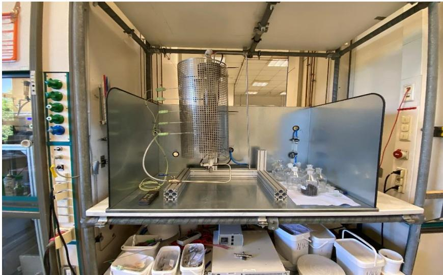
Abbildung 42: Aufbau des ESFA-Reaktors
