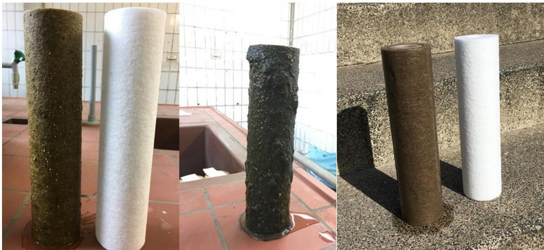
Abbildung 66: Belegung der Vorfilterkerzen: links: kommunale Anlage, 2 d Betrieb; Mitte: vermehrtes Algenaufkommen; rechts: industrielle Anlage, 2 d Betrieb
